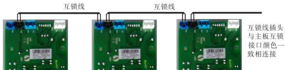
图3-9 互锁的接线图
